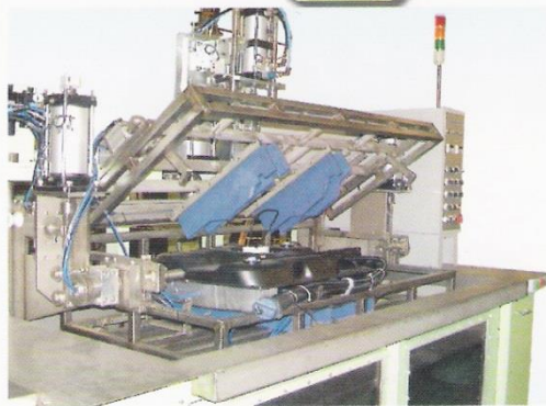
SEAM 용접 후에 수물 TEST M/C
