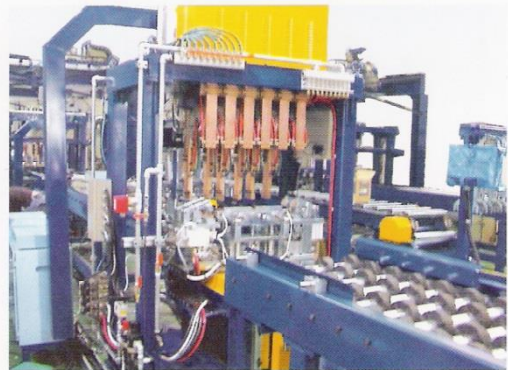
T/G와 DECK를 용접 & TOX JOINT 하는 장비
