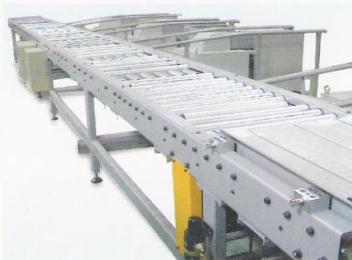
완제품 반송 및 단부재 (CO 2 용접장치)
