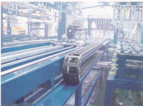
T/G와 DECK를 FEEDING 자동공급 하는 장비
