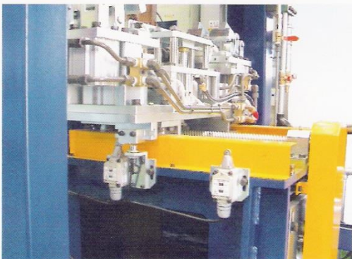
T/G와 DECK를 용접 또는 TOX 후 FEEDING 하는 UNIT
