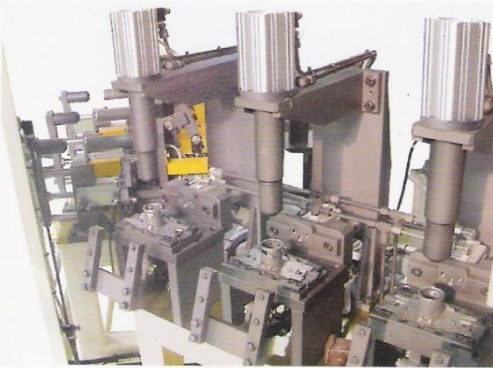
EN BRACKET WELDING JIG
